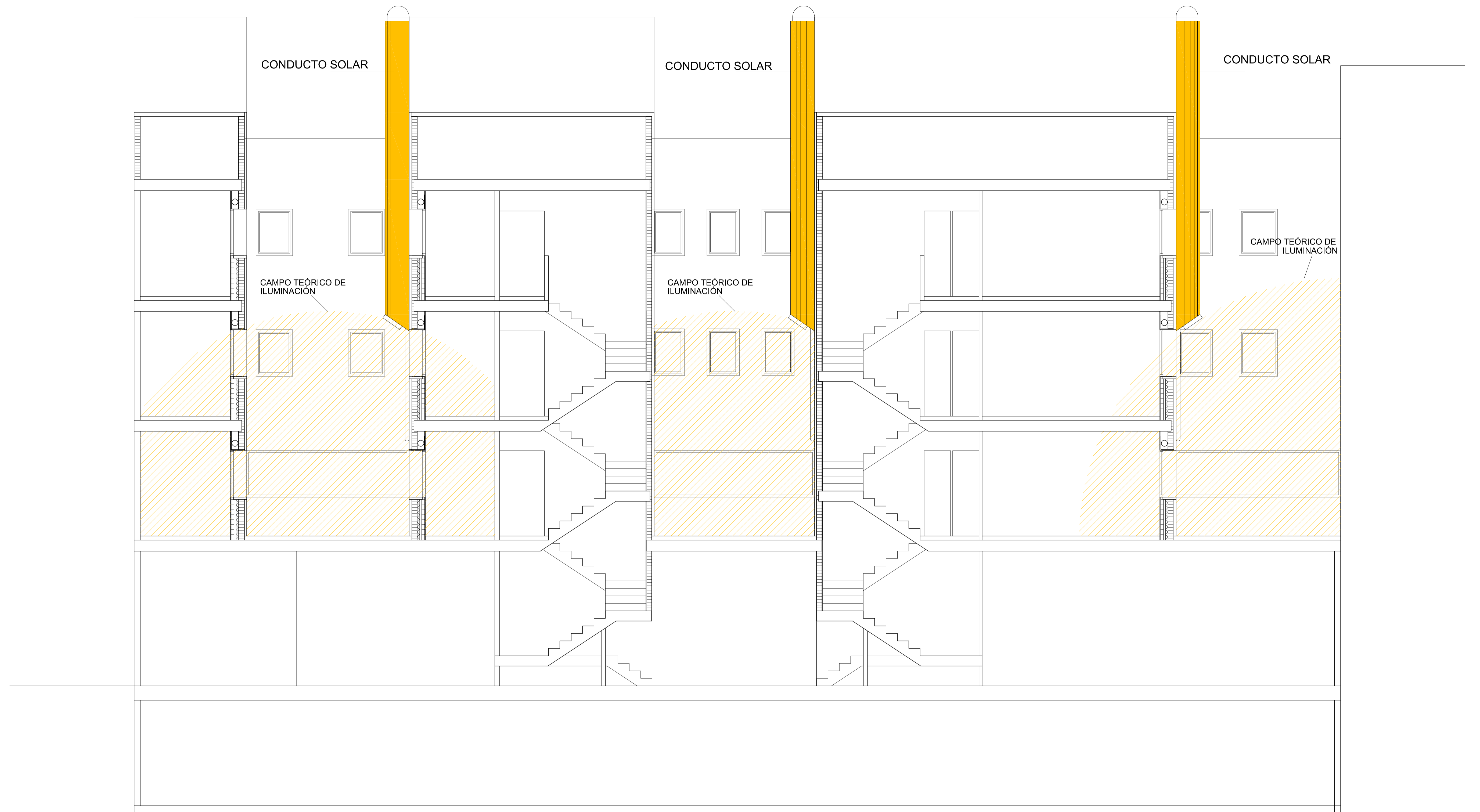
EDIFICIO A. SECCIÓN LONGITUDINAL
