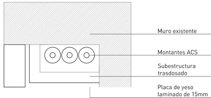
DETALLE DE PASO DE INSTALACIONES POR PLANTA. INCLUSO PERFORACIÓN EN FORJADO
