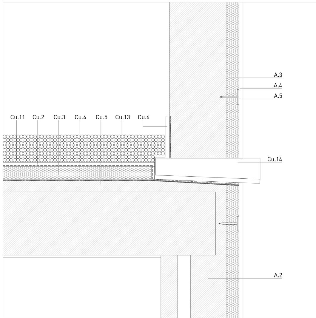
DETALLE DE GÁRGOLA EN CUBIERTA PLANA NO TRANSITABLE.
