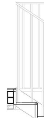
Detalle en sección · Desembarco escalera
