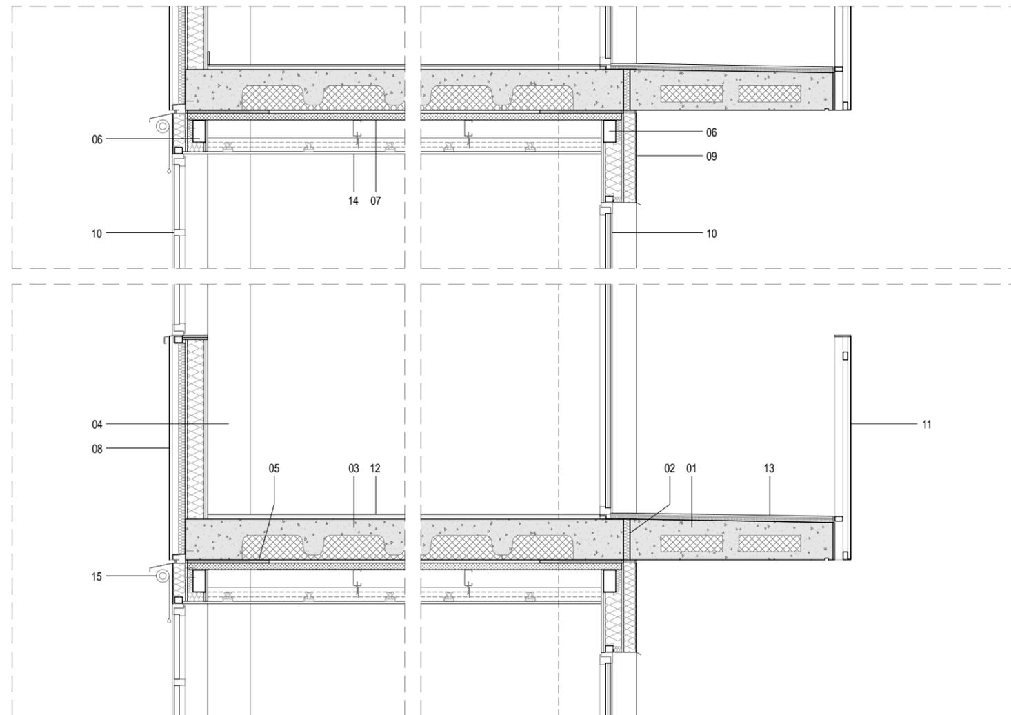
01 Losa nervada de hormigón armado con aligeramiento de EPS
